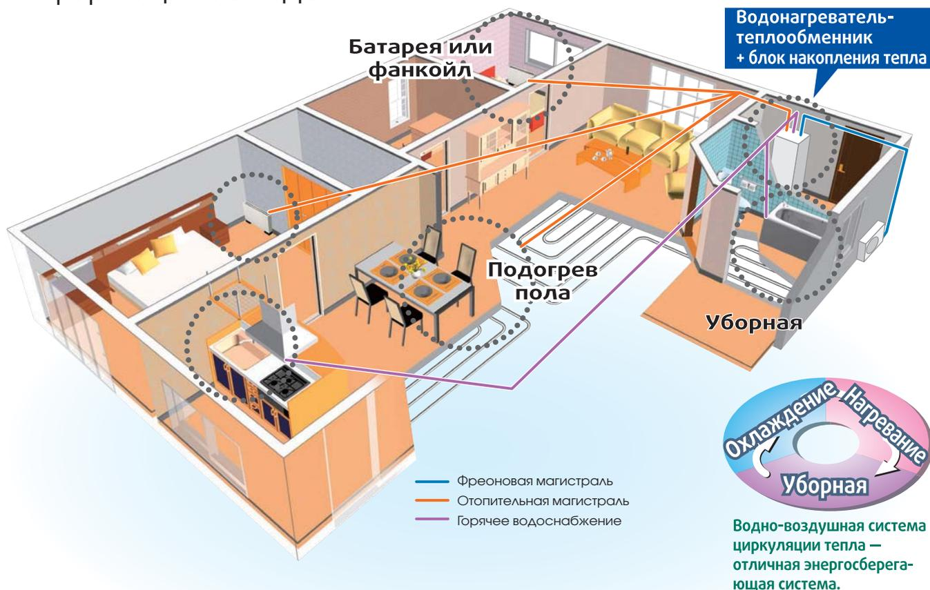
Тепловой насос «Воздух-вода» — это современная система, предназначенная для отопления, охлаждения и горячего водоснабжения зданий, которая способна обеспечить минимальное энергопотребление и воздействие на окружающую среду. Тепловой насос — безопасное и экономичное устройство. В его внутренний блок встроены: теплообменник «фреон/вода», бак для воды со встроенными змеевиковым теплообменником и погружным электронагревателем, циркуляционный насос.
