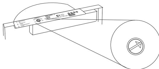
Рис. 2. Настройка таймера на BF 100T
