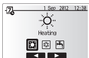
Выбор режима для автоматической работы по таймеру
