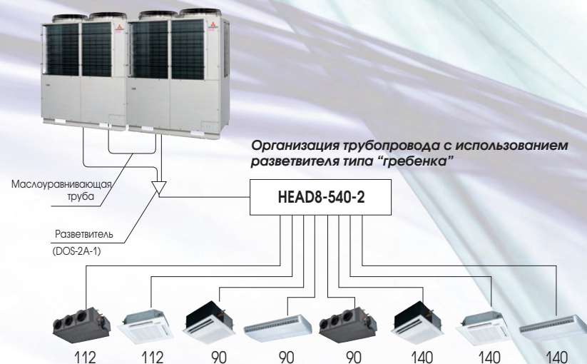
Разветвитель трубопровода нар. блоков
